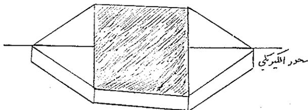
و این تیغه متوازی السطوح که در شکل قبل مجسم شده و تصورش آسان میباشد در گیره ای فولادی بگذاریم بطوریکه صفحات گیره فولادی بر روی سطح کوارتز قرار گرفته باشد و این دو صفحه فولاد را بدو قطب یک الکترومتر متصل کنیم .
