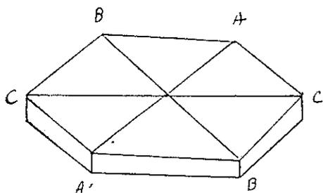
در این مقطع خطوط الکتریکی بلور مینامند و بلور نسبت به این محورها دارای تقارن درجه دوم است.
