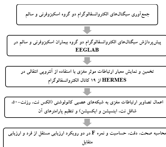
شکل ۱: بلوک دیاگرام تشخیص افراد اسکیزوفرنی از سالم از سیگنال‌های ۱۹ کاناله الکتروانسفالوگرام مبتنی بر یادگیری عمیق و ارتباطات مغزی
